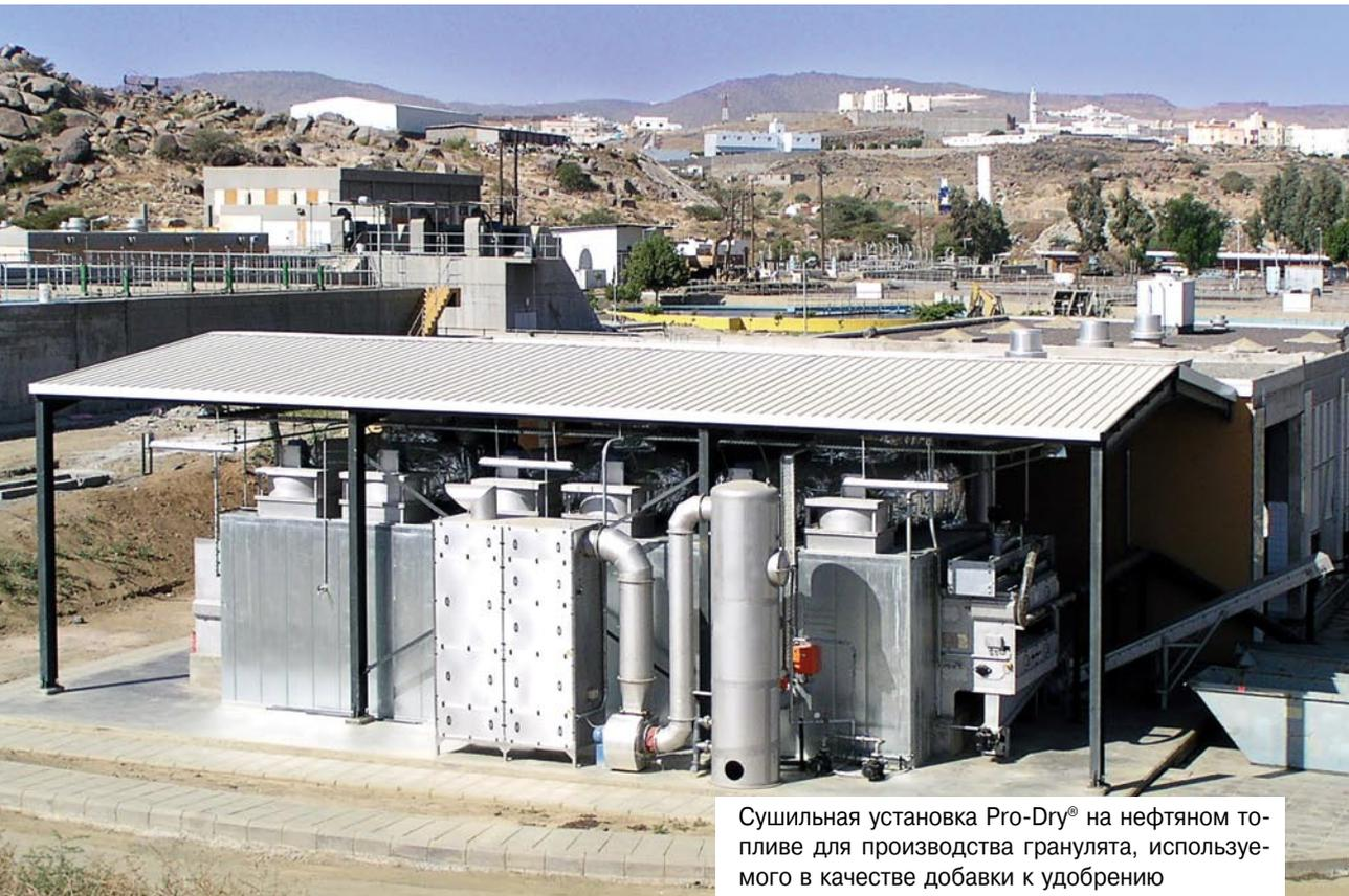
Сушильная установка Pro-Dry® на нефтяном топливе для производства гранулята, используемого в качестве добавки к удобрению
