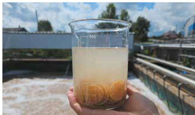
Рис. 3. Реактор с плавающей загрузкой во взвешенном слое (MBBR)
